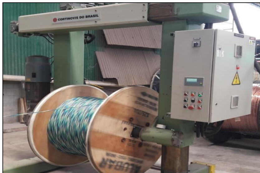
Figura 12 – Cabos reunidos acondicionados em carretéis de madeira
