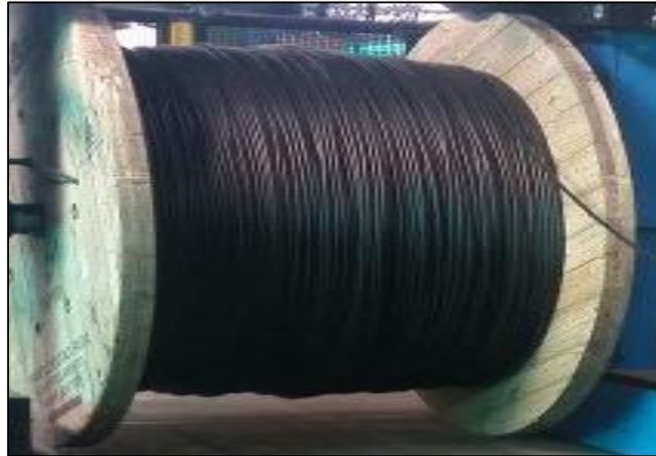
Figura 10 – Cabo de cobre isolado acondicionado em carretel de madeira
