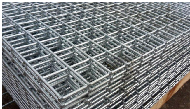
Figura 85 - Armadura de aço
