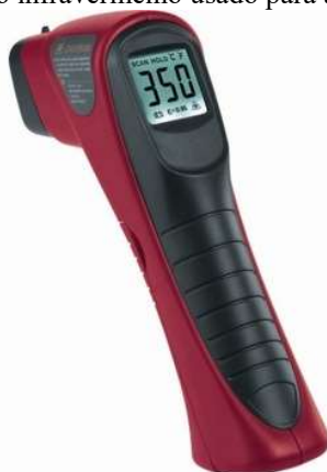
Figura 18: Termômetro infravermelho usado para a coleta de dados
