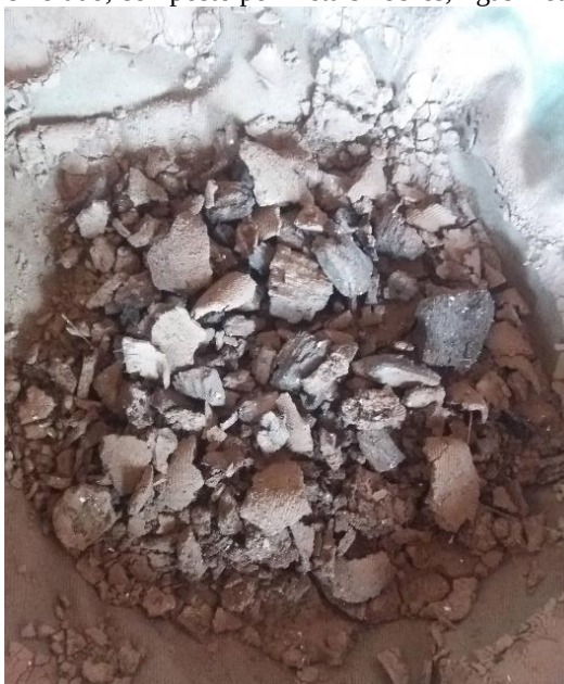
Figura 30: Lixo de ourivesaria incinerado, composto por metais nobres, ligas metálicas e material orgânico
