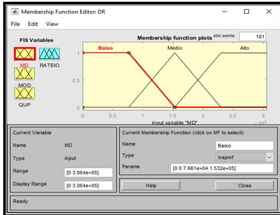
Figura 12: Modelo do FIS com seus inputs , range e output .
