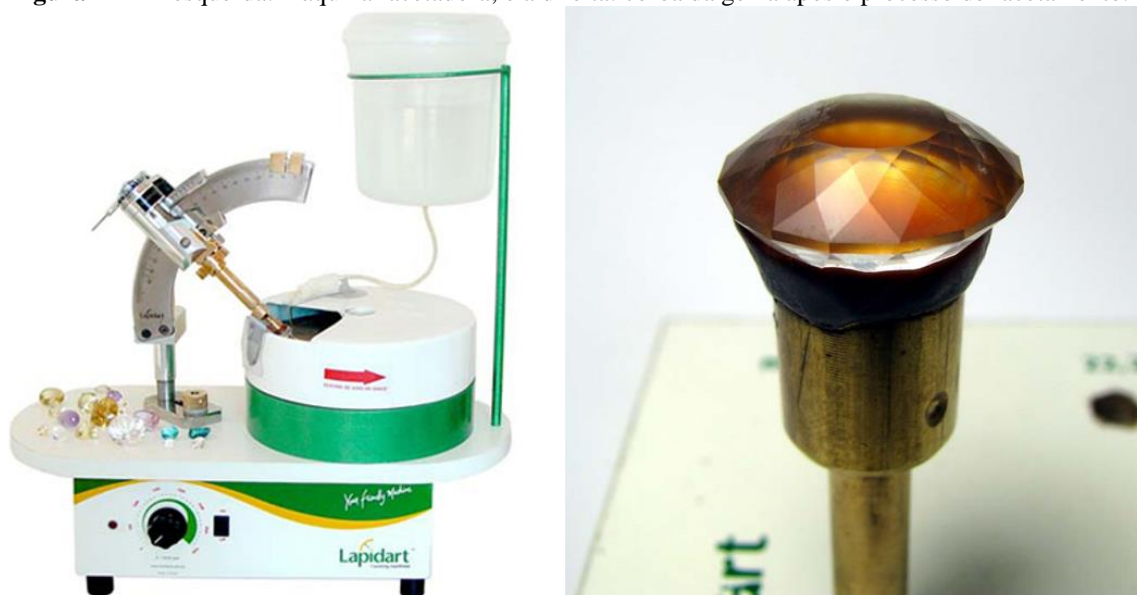
Figura 27 – A esquerda: máquina facetadora; e a direita: coroa da gema após o processo de facetamento.
