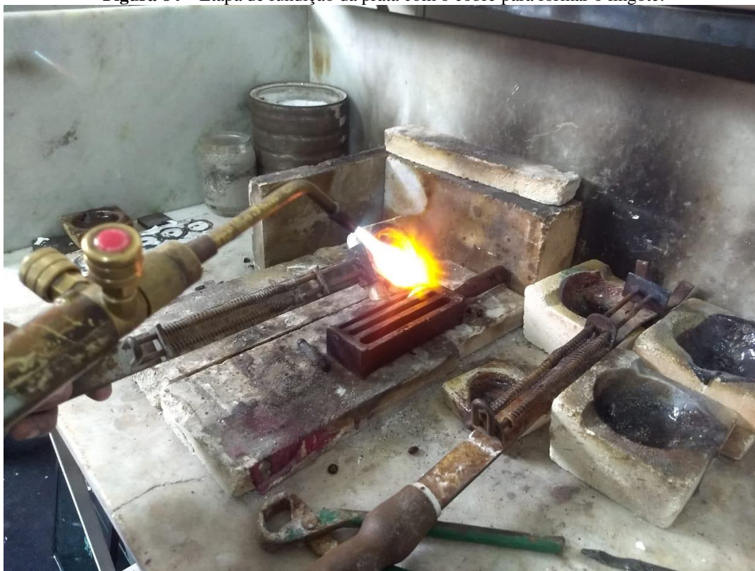
Figura 84 – Etapa de fundição da prata com o cobre para formar o lingote.
