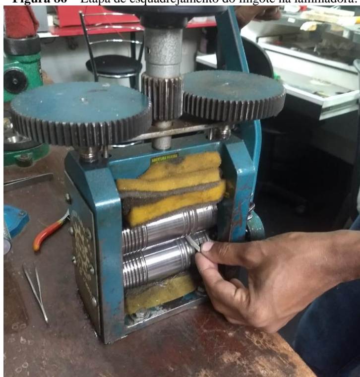
Figura 86 – Etapa de esquadreamento do lingote na laminadora.
