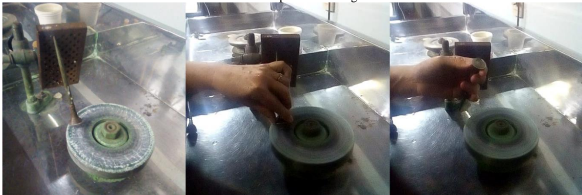
Figura 34 – Da esquerda para a direita: o maquinário para a lapidação tipo “tabuinha”; realização do polimento das facetas da gema com o auxílio da tabuinha, na qual a caneta de madeira é apoiada; e observação do andamento do polimento da gema.
