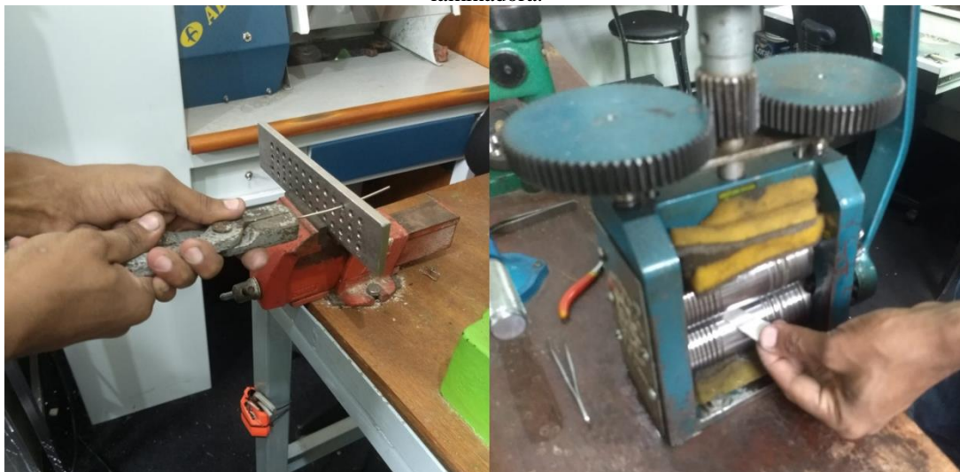
Figura 87 – Da esquerda para direita: fio de prata sendo passado na fiadora; e chapa de prata sendo passado na laminadora.
