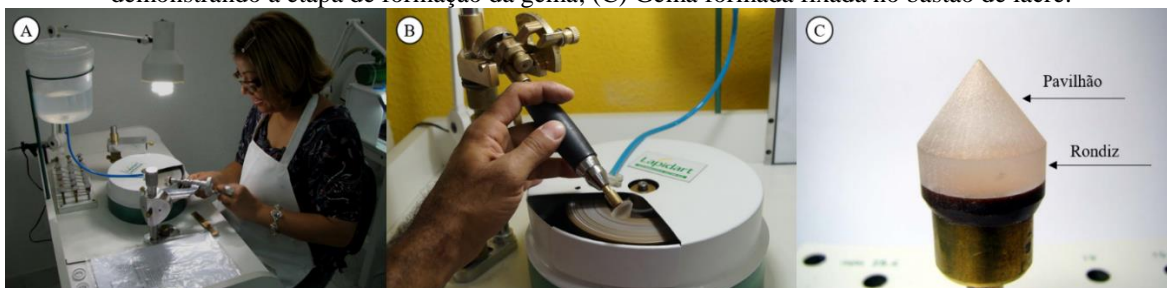
Figura 26 – Da esquerda para direita: (A) Lapidária trabalhando na calibradora; (B) Máquina calibradora demonstrando a etapa de formação da gema; (C) Gema formada fixada no bastão de lacre.
