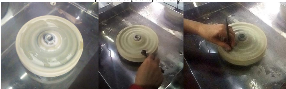
Figura 35 – Da esquerda para a direita: Disco de feltro umedecido com água; polimento do rondízio da gema; e polimento da parte superior da gema.
