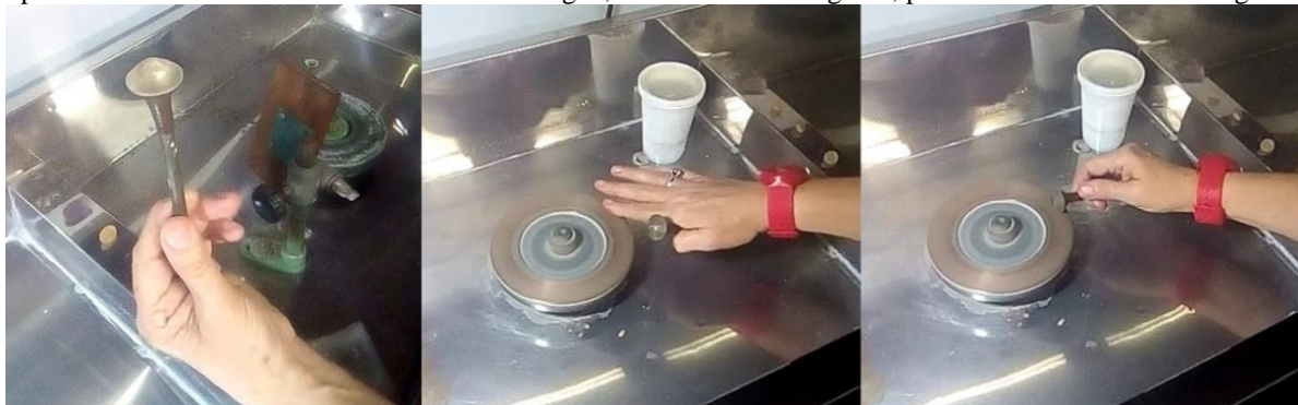
Figura 33 – Da esquerda para a direita: Caneta de madeira, com a gema já colada na ponta com goma laca; a lapidária umidecendo o disco diamantado com água, antes de facetar a gema; processo de facetamento da gema.
