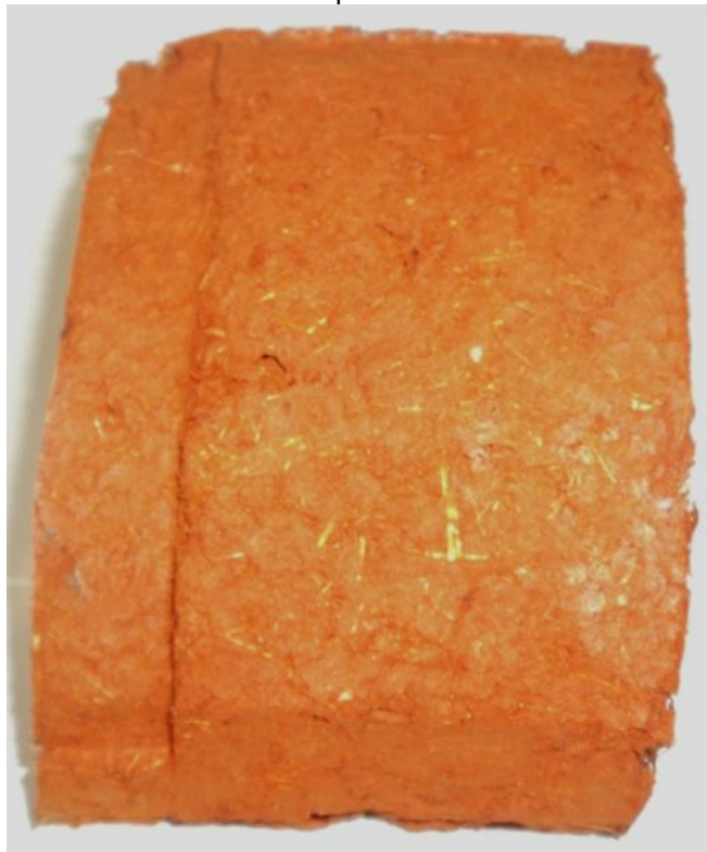
Figura 37: Contraste entre o opaco e o brilho das fibras do jupati
