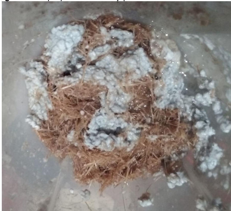
Figura 28: Papel pós-consumo e jupati triturados sendo misturados
