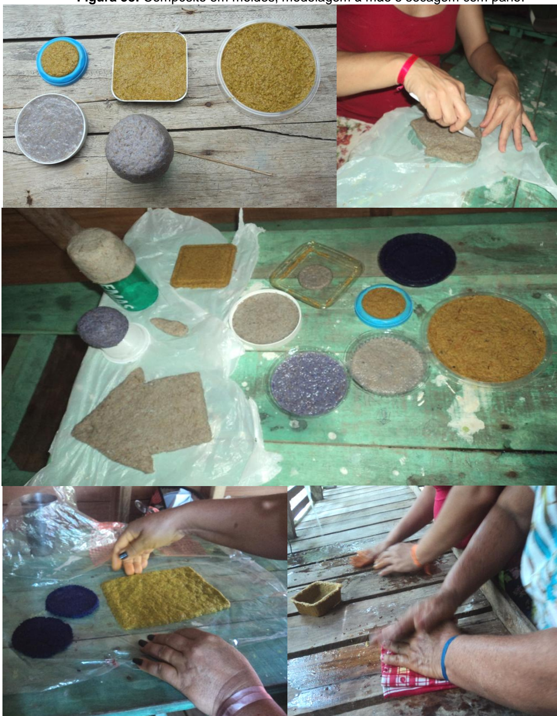
Figura 58: Compósito em moldes, modelagem à mão e secagem com pano.
