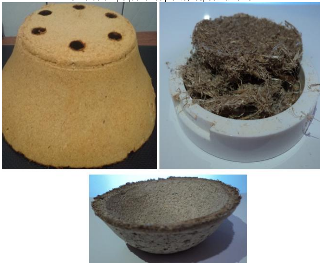
Figura 43: Amostras realizadas sem o cozimento do resíduo- vaso, forma redonda não aglutinada e forma de um pequeno recipiente, respectivamente.
