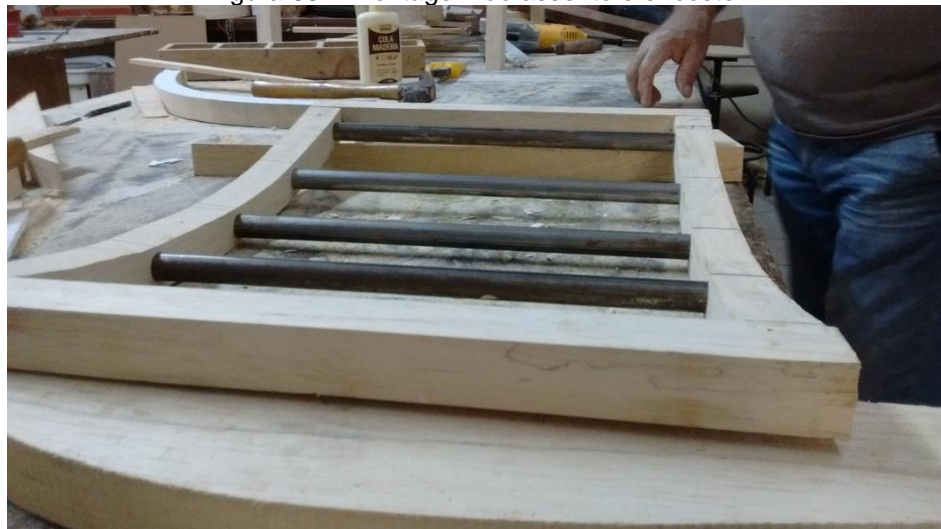
Figura 68 – Montagem do assento e encosto.
