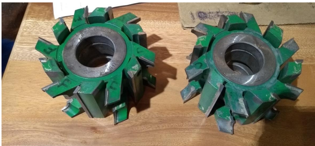
Figura 22 – Ferramenta para quebra de canto na moldureira
