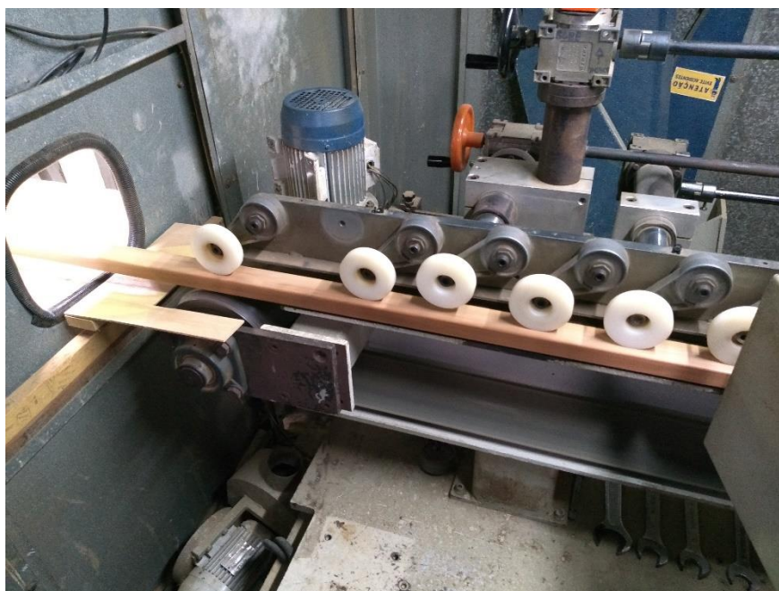
Figura 24 – Processo de lixar lateral 1 feito depois
