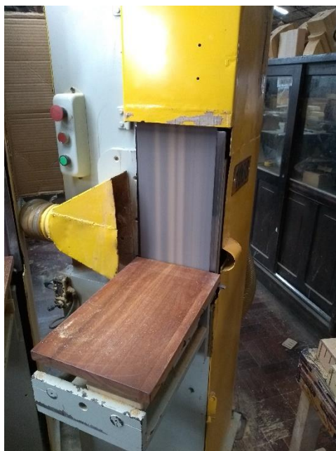
Figura 23 – Processo de lixar lateral 1 feito antes
