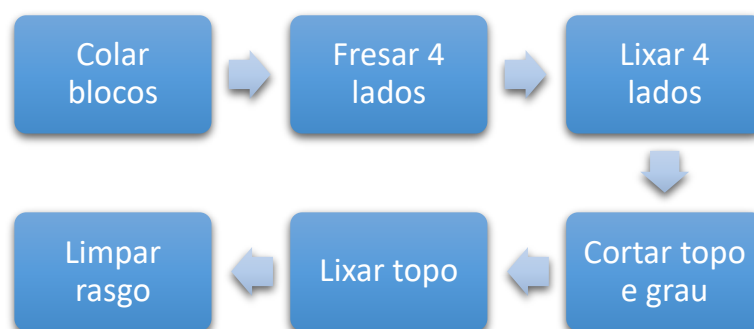
Figura 33 – Fluxo do processo do bloco superior para os três modelos selecionados (depois)
