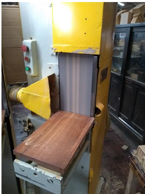
Figura 27 – Processo de lixar topo antes do estudo
