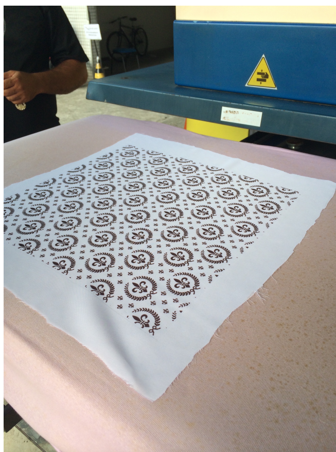
Figura 81 Aplicação da estampa através de sublimação.
