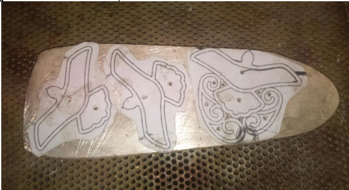
Figura 44 – Antes do corte da chapa em Prata.
