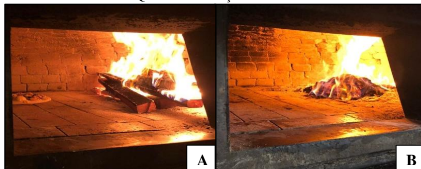
Figura 12: Processo de combustão das biomassas para produção de pizzas. A: Queima da lenha; B: Queima dos caroços cominuídos.
