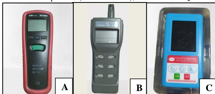
Figura 6: Medidores de emissões de gases e particulados. A: Medidor de Monóxido de Carbono (DG-5080); B: Medidor de Co2 e Temperatura (Rosh JSM-131); C: Detector de Qualidade do Ar (Kailishen)
