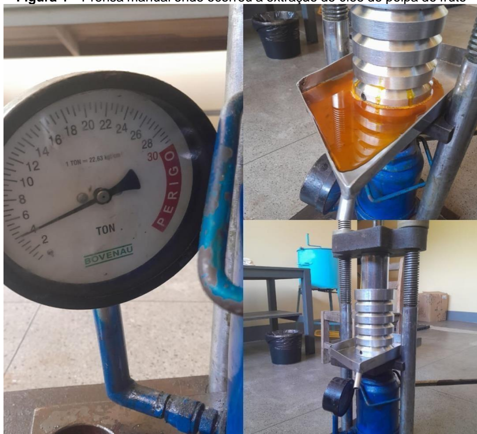
Figura 4 – Prensa manual onde ocorreu a extração do óleo do polpa do fruto
